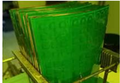
图表 9：阻焊曝光+显影后，PCB 电路板实现绿油开窗
