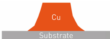
图表 1：mSAP 相较减成法抑制侧蚀，铜线路侧壁接近垂直
